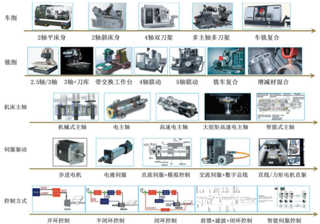
图表11: 机床技术升级体现在机床结构、主轴、驱动、控制等方面
