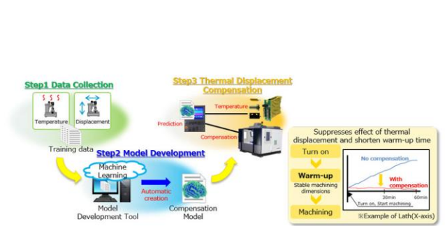
图表38：发那科采用机器学习的 AI 热误差补偿功能
