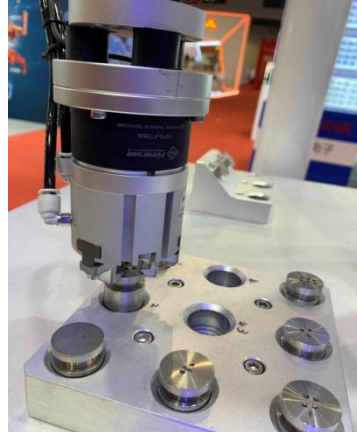
图18:六维力传感器用于机器人柔性精密装配
