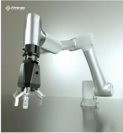
图17:六维力传感器用于机器人力控曲面打磨
