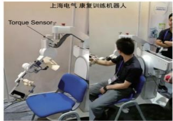
图23:六维力传感器用于康复训练机器人
