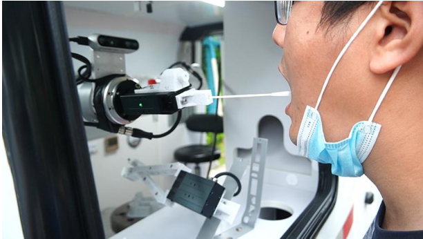
图22:六维力传感器用于核酸采样检测机器人
