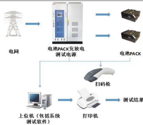
图22： 大功率测试电源对动力电池进行测试
