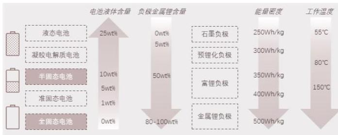
图表 34：主流负极材料性能对比
