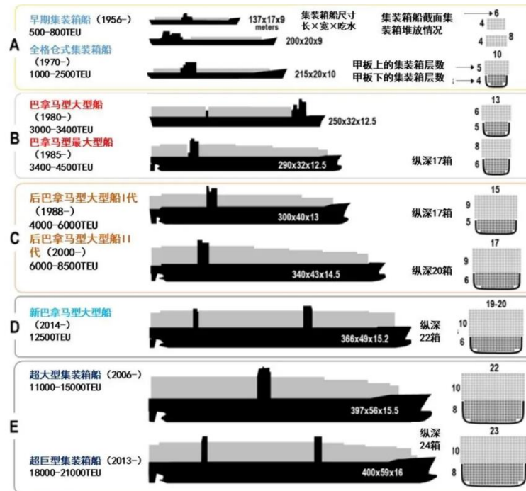
图14：集装箱船舶的大型化：港口起重机需要更大的起升能力、延伸长度、起升高度、和自重
