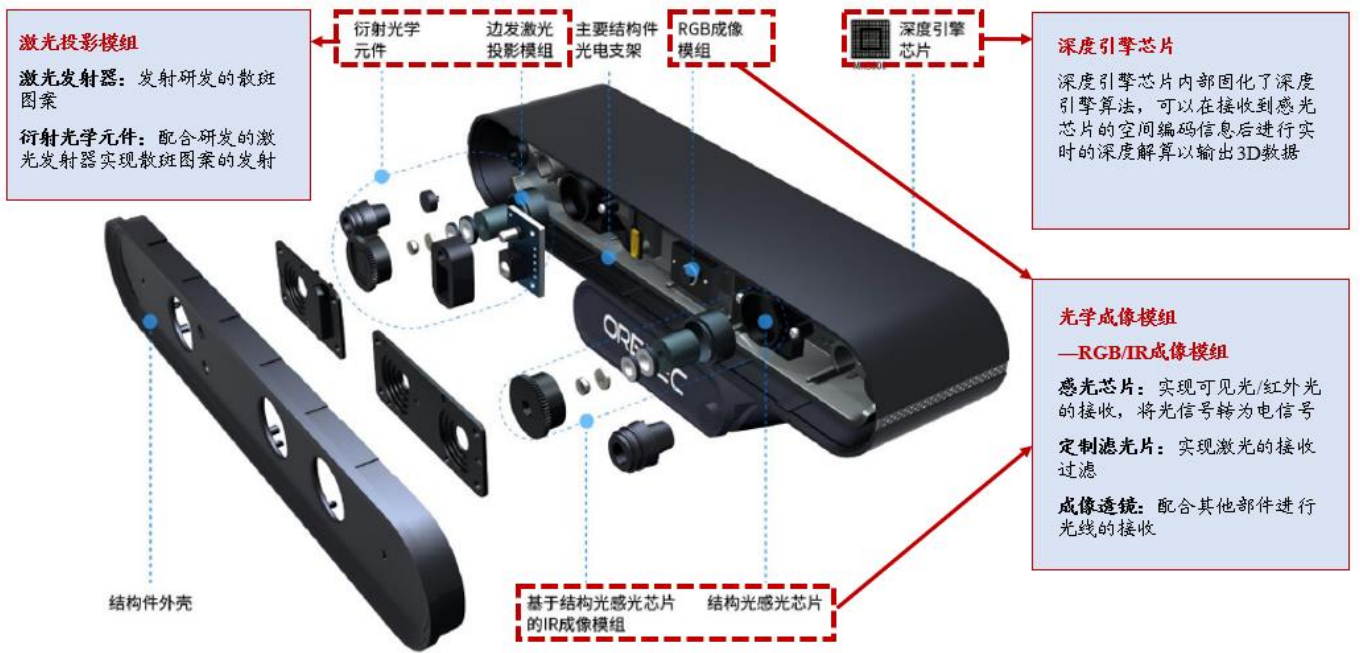
图18: Astra 系列 3D 视觉传感器内部构造示意图
