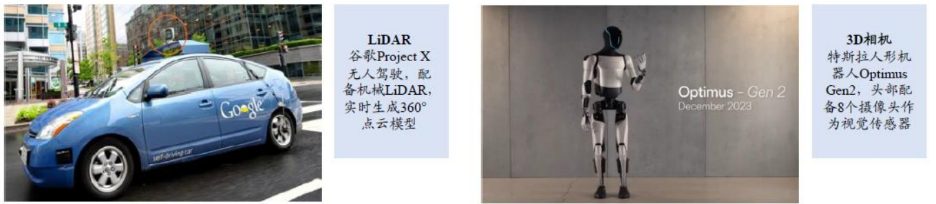
图63: 3D 视觉可通过 LiDAR 和 3D 相机实现
