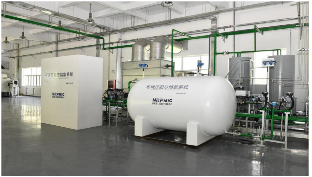
图表43: 全国首台套固态储氢系统示范装置亮相北方稀土
