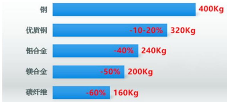
图：碳纤维和金属材料性能对比
