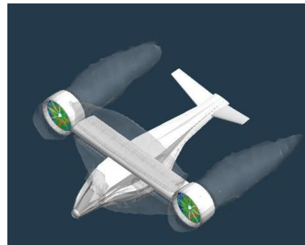
图26：倾转涵道中保真 CFD 流场预测（巡航状态）
