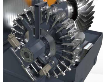
图33 六轴叶盘加工中心配备 48 把双排圆盘式刀库
