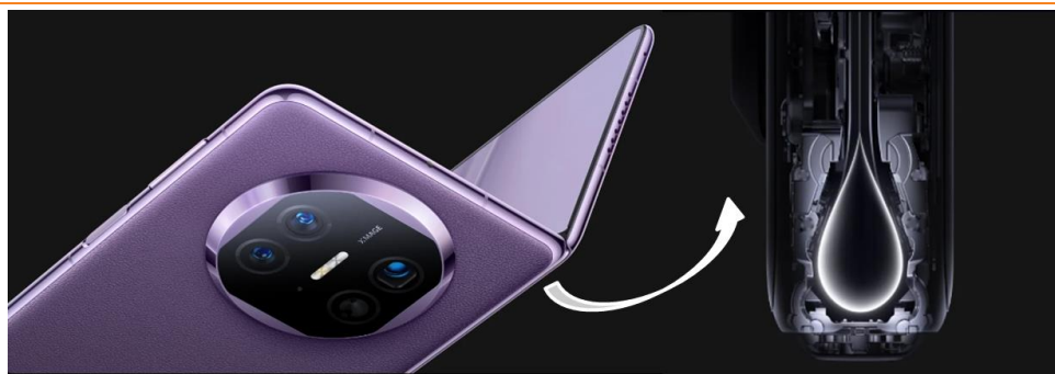
图 18：华为 Mate X5 折叠机身及水滴铰链示意图
