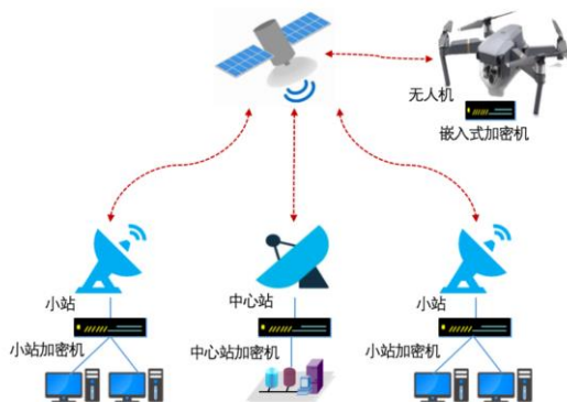
图6：天御云安的卫星通信加密系统部署
