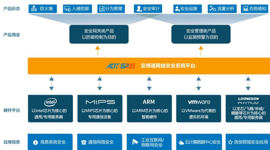
图10: SPOS 网络安全系统平台架构
