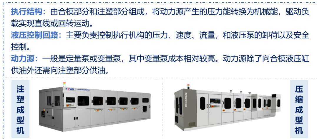
图表21：塑封机设备图与子系统
