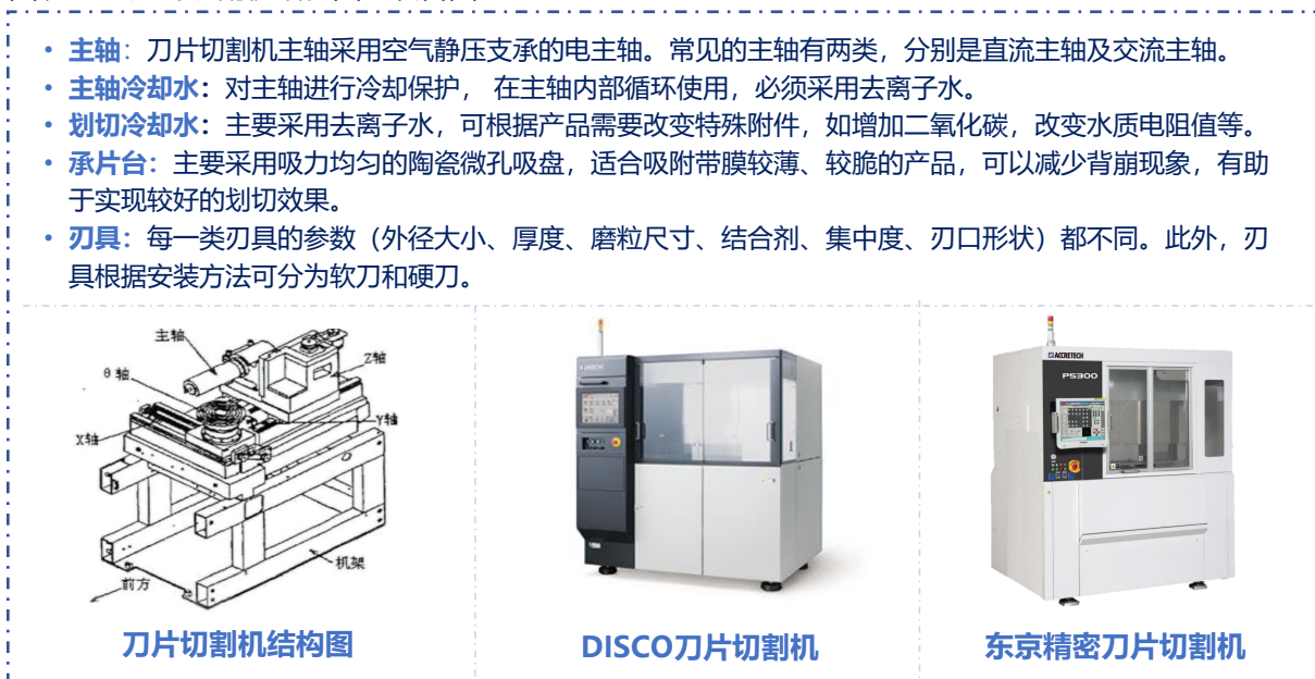
图表15：刀片切割机结构图与设备图
