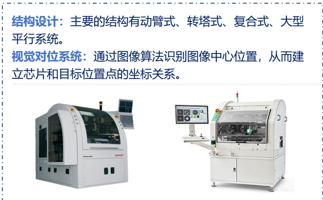
图表18：贴片机设备图和子系统
