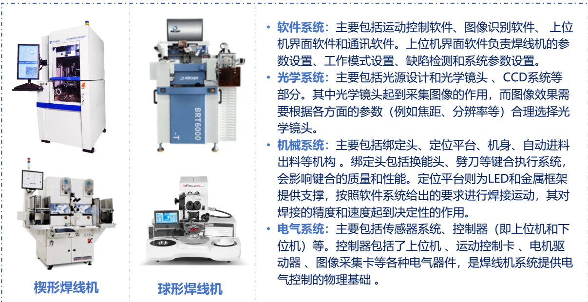
图表20：焊线机设备图与子系统
