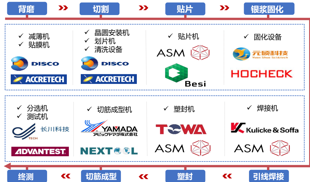
图表9：集成电路后道工艺流程、对应设备及主要生产商
