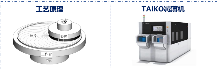
图表13：TAIKO工艺原理图及设备图
