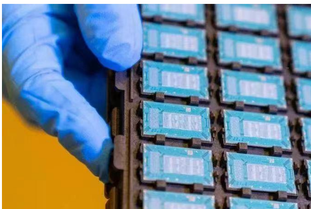
图5: 玻璃基板系统级封装原型
