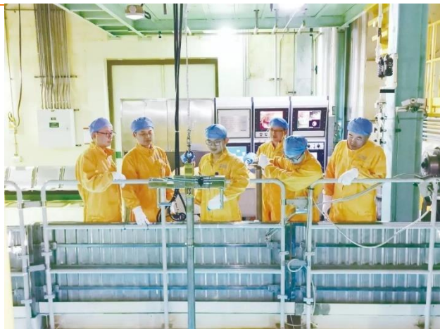
图 10：工作人员正在进行钴-60 出堆操作
