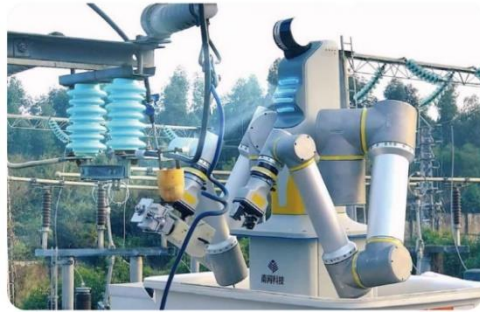
图44： 公司“擎天”配网带电作业系统
