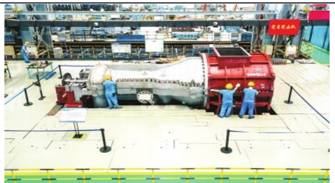
图58. 东方电气为金坛压缩空气储能电站提供膨胀机组
