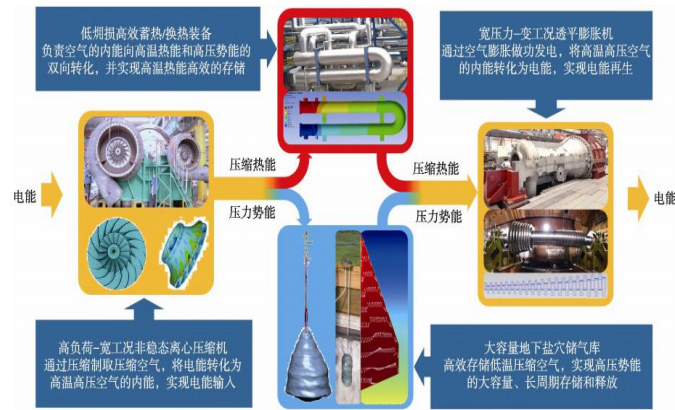
图54. 压缩机、膨胀机、蓄热、储气装置为核心设备
