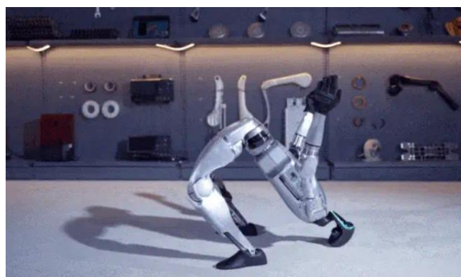
图6: 宇树 Unitree 可实现原地平躺起身、腿部折叠等大角度动作
