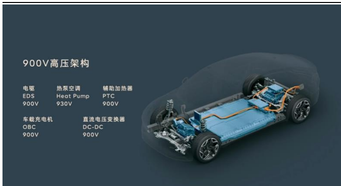
图62：乐道 L60 系 NT3.0 平台首款车型，基于全 900V 高压架构，和蔚来旗舰车型 ET9 技术同源
