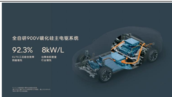
图63：乐道 L60 全自研 900V 碳化硅主电驱系统 CTLC 工况下综合效率达 92.3%
