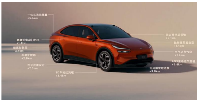
图64：乐道 L60 通过多重外形设计将 120km/h 状态下风阻系数降低至 0.229
