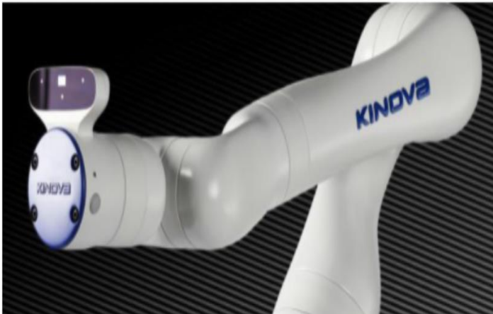
图16: 7 自由度机械臂总重量仅有 8.2kg
