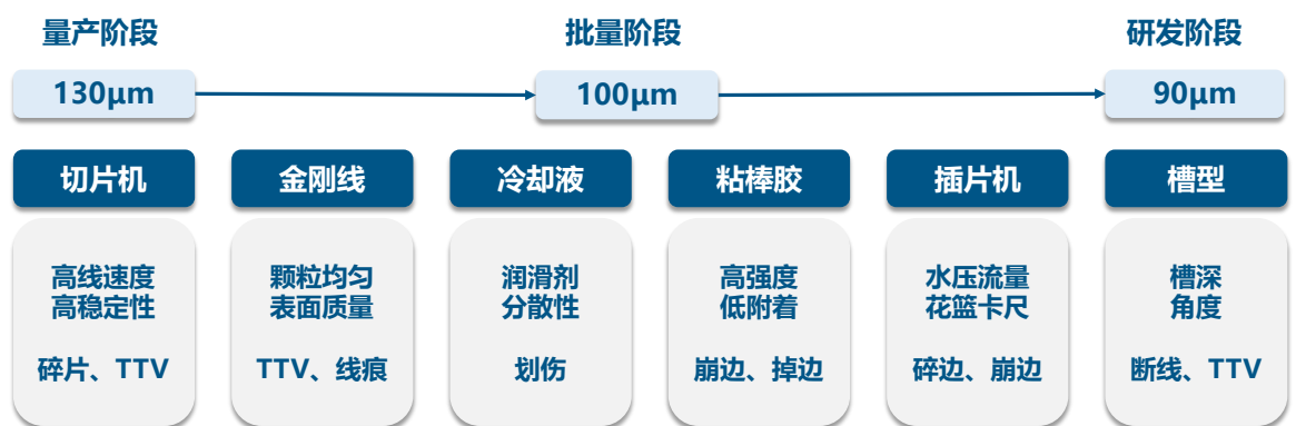
图表24: 薄片化趋势下所需攻克的关键技术
