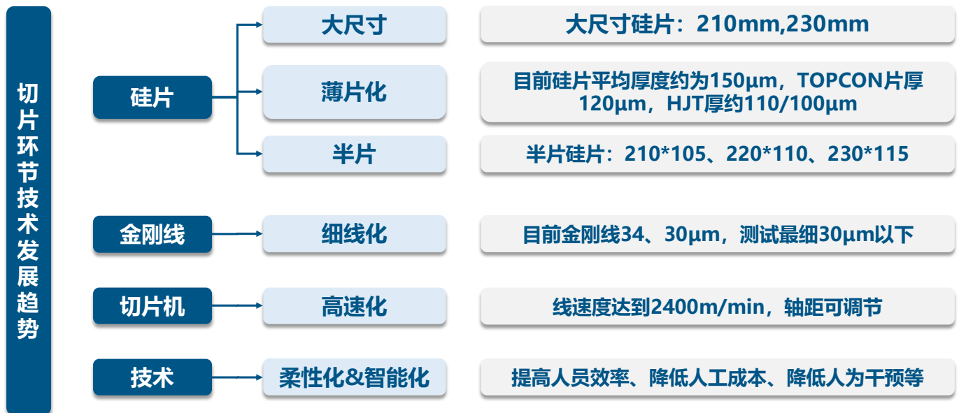
图表22：切片环节的技术变化多，包括硅片的大尺寸、薄片化；设备和耗材的高速度和细线化
