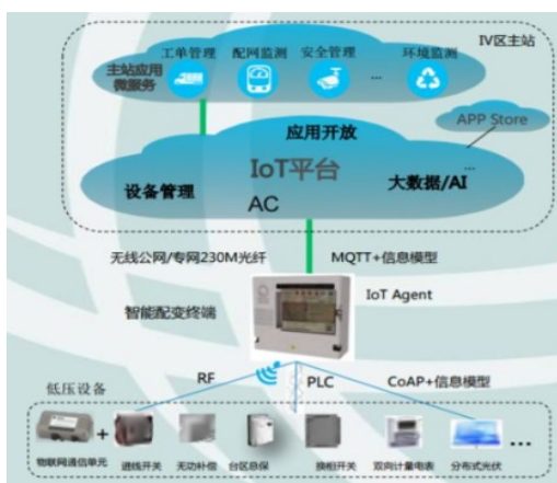
图10: 配电网物联网解决方案架构
