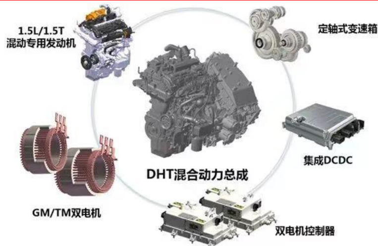
图 12：“七合一”高效能多模混动总成
