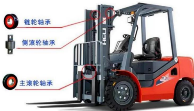
图16: 万达轴承产品在叉车门架系统的应用场景
