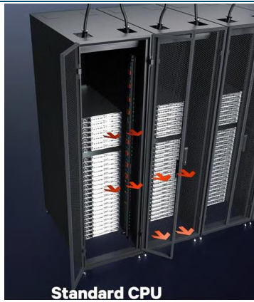
图表4: 普通服务器通常采用风扇风冷
