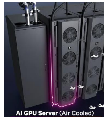
图表5: 采用风冷的AI服务器需要再机柜加装空调
