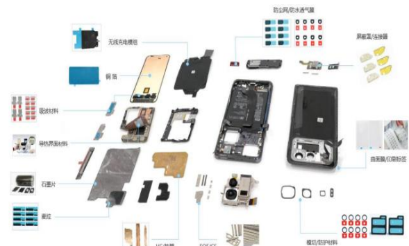
图 9：手机内部的电磁屏蔽等相关器件
