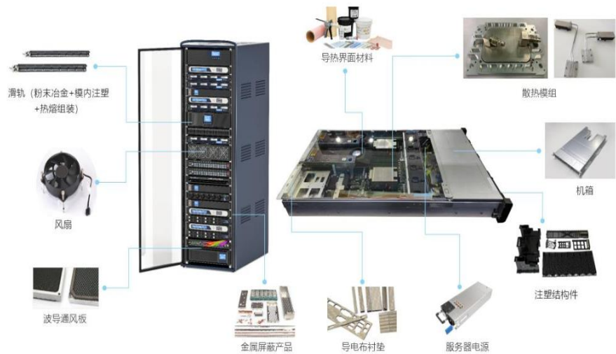
图 5：服务器内部的电磁屏蔽等相关器件
