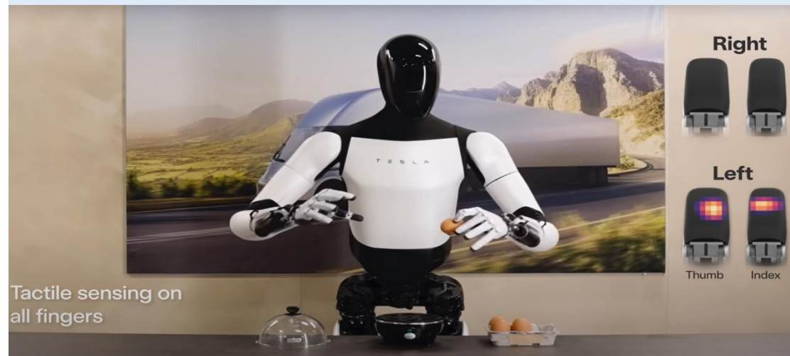
图：Optimus-Gen 2的每个手指上都有触觉传感器
