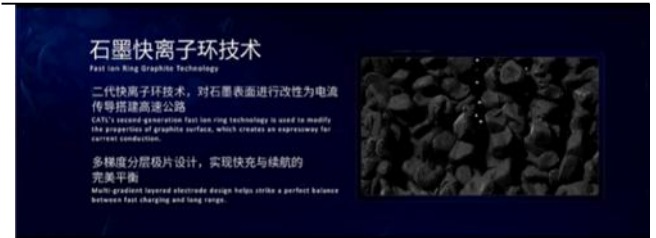
图 44：宁德时代神行电池石墨负极表面修饰技术
