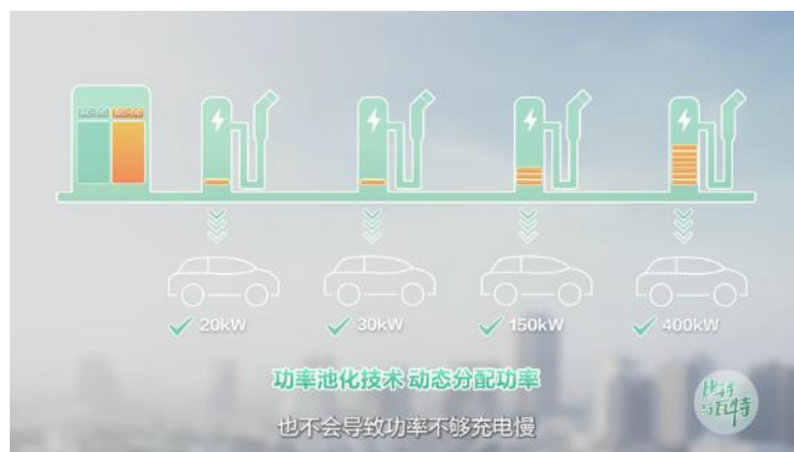
图 63：华为数字能源功率池化和功率柔性智能分配技术
