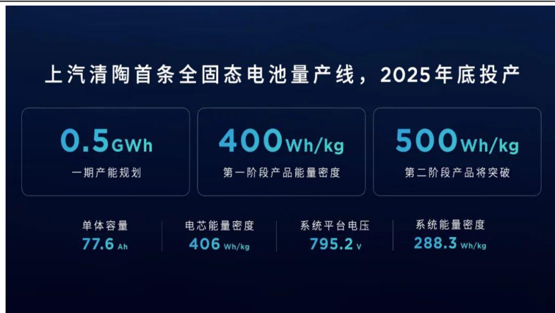
图2: 上汽清陶全固态电池量产线基本情况
