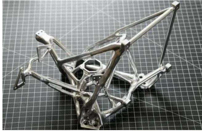
图 18：生成式 AI 制作的阿斯顿·马丁全跑车后车架部件
