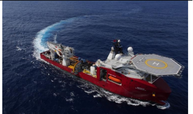
图19:公司的深水多功能水下工程船
