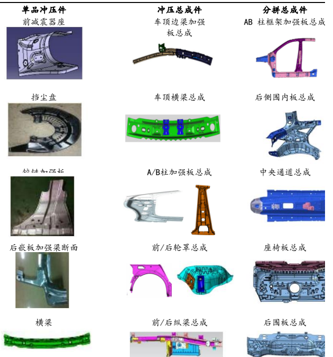
图28:冲压单品件、总成件、分拼总成件情况
