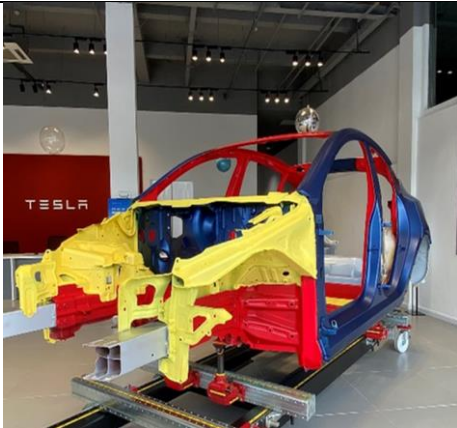
图35:特斯拉 Model Y 白车身结构
