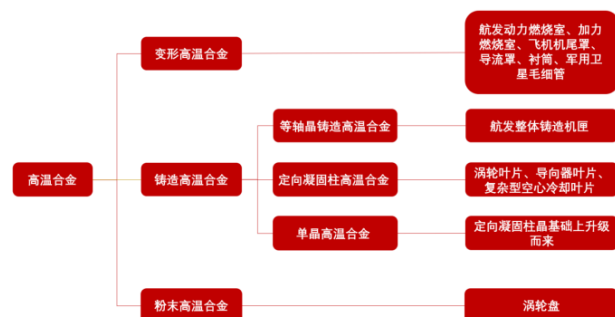
图 10：高温合金按材料成型方式分类及应用
