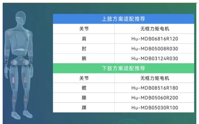
图 5: Hu-MDB 无框力矩电机可满足人形机器人各关节需求
