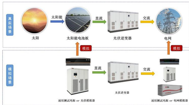
图11: 光伏逆变器测试需应用光伏模拟器、电网模拟器或通用测试电源
