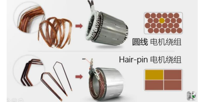
图31.扁线绕组截面大，能有效降低电阻，减少铜耗
