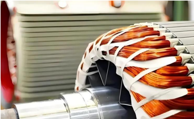
图28.圆线电机示意图
