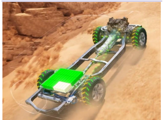
图 20：Hi4-T 的油电并联架构适配越野多种场景
