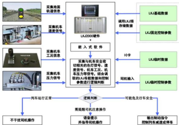
图表 9 以机车为例的列车运行控制系统
