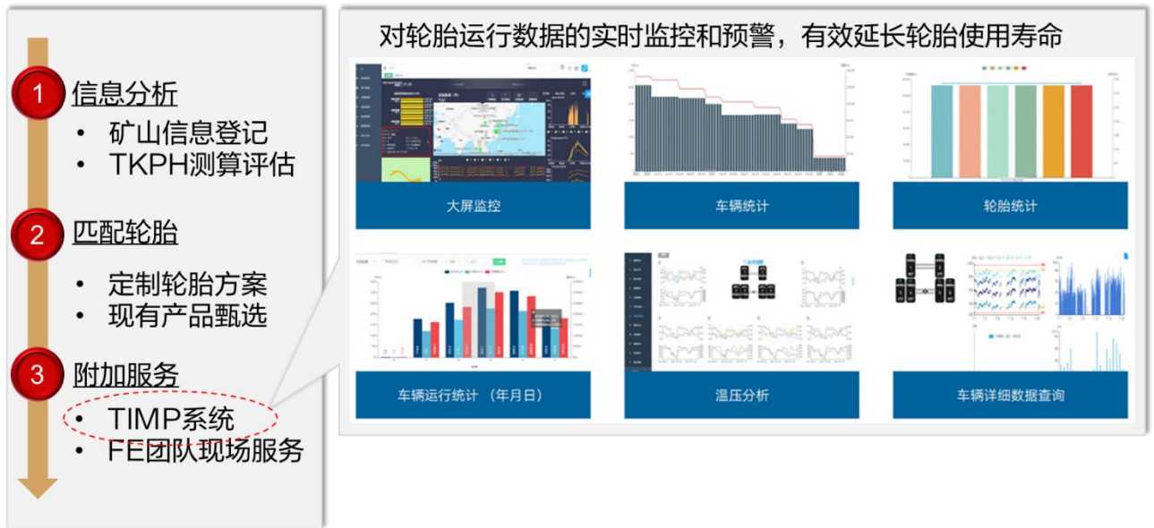
图58 赛轮 TAMP 系统对轮胎运行实时监控及预警
