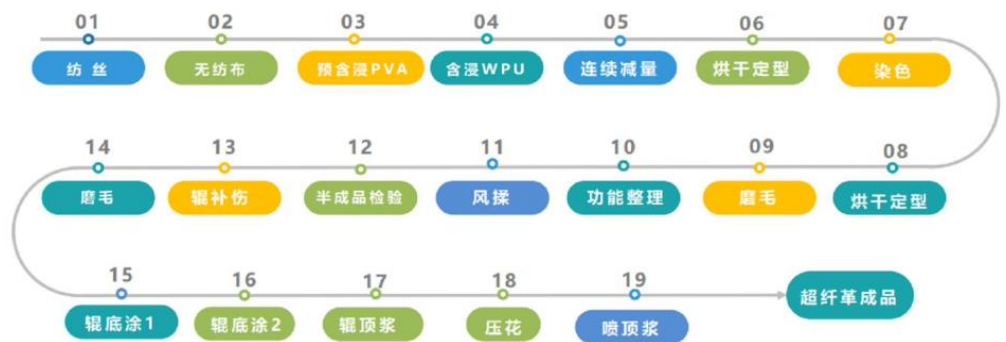
图 24：公司超纤革生产工艺流程
