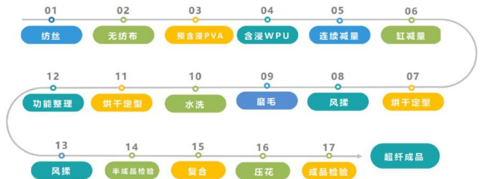
图 23：公司绒面超纤革生产工艺流程
