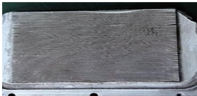
图37：冷板内部流道结构图
