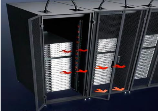
图20：风冷可满足传统 CPU 服务器机柜散热需求
