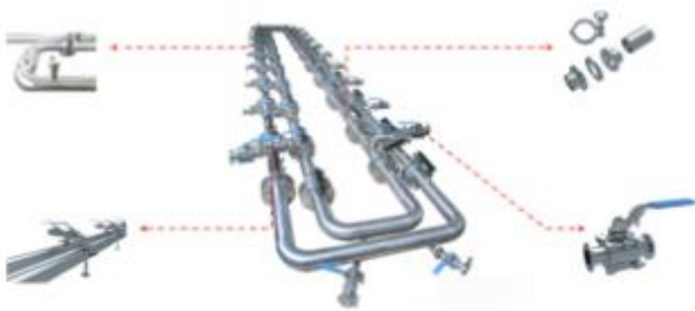
图40: 环形液冷管路示意图
