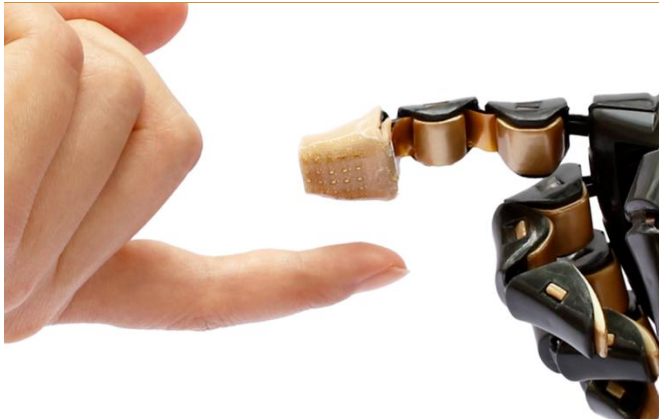
图 10：装有仿生三维电子皮肤的机械手与人手互动
