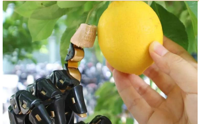
图 11：仿生三维电子皮肤在触摸柠檬感知其软硬程度
