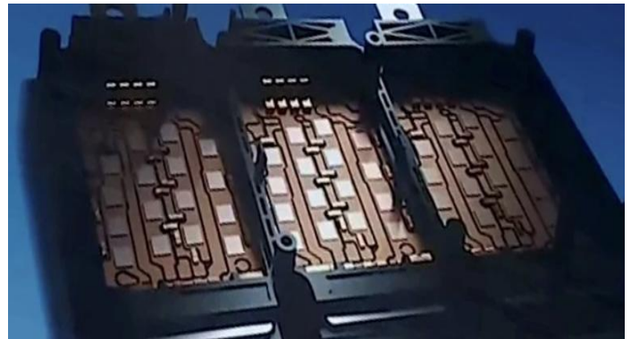
图 89: 12 合 1 的电驱全系搭载 1200V 碳化硅电控
