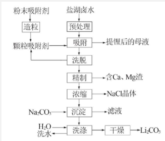
图：吸附法从盐湖卤水中提取碳酸锂生产工艺流程图
