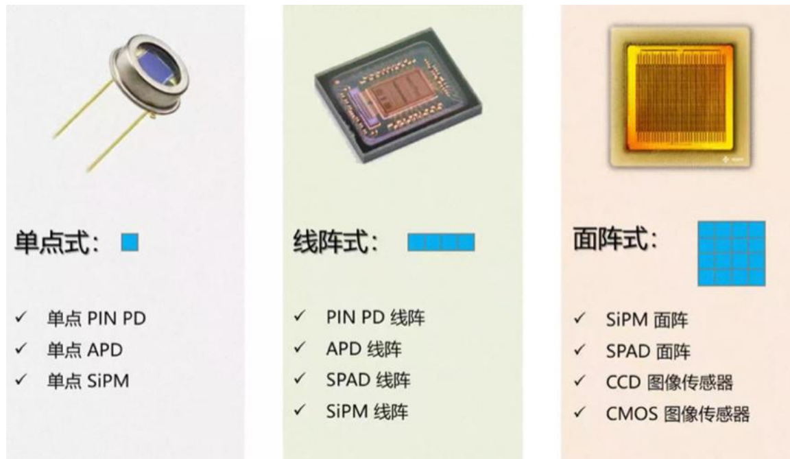
图表：应用于激光雷达的光电探测器从“点”向“面”进化并普及
