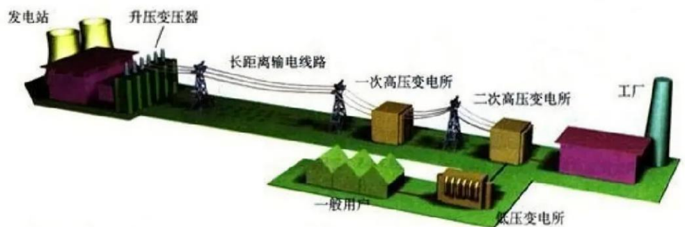
图 35：电力“发、输、变、配、用”流程
