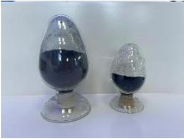
图10：磷酸铁锂正极材料为黑色粉末状固体
