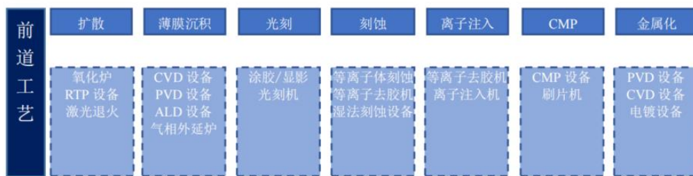
图 95：集成电路前道制造工艺流程主要设备
