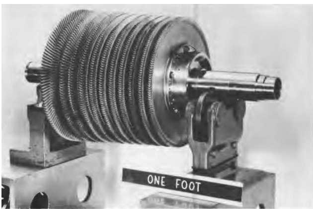
图7：早期液氢发动机的高压涡轮叶片
