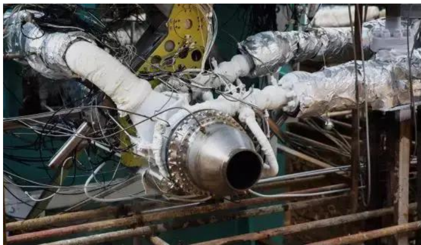
图10：“天鹊-12” 甲烷发动机涡轮泵
