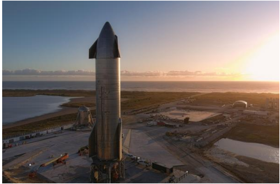
图15：星舰采用不锈钢箭体
