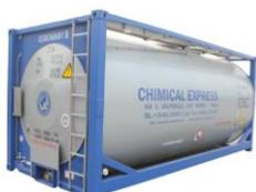
主要用来装载液体货物，如酒精、汽油、化学品等。分为罐体和框架两部分结构，罐体用于装载液体，框架用于支撑和固定罐体。
