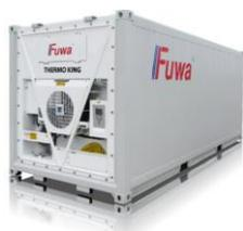
主要用来装载冷冻、保温、保鲜的货物，如水果、时蔬、海鲜等。配备冷冻设备、内壁铺设导热率低的材料。
